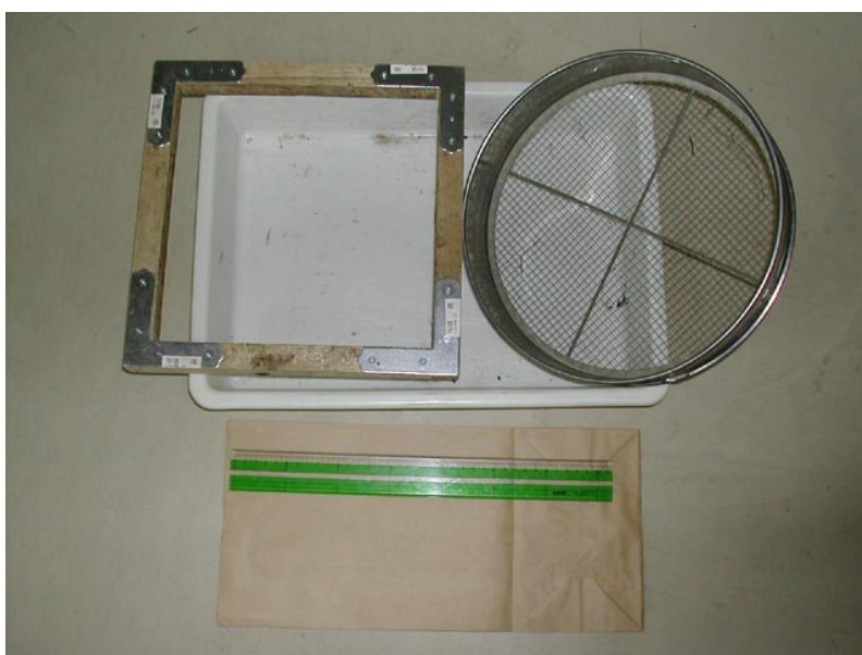
図-1 調査道具（内寸 25cm 角木枠、5mm 篩、トレイ、サンプル収納紙袋、メジャー）
